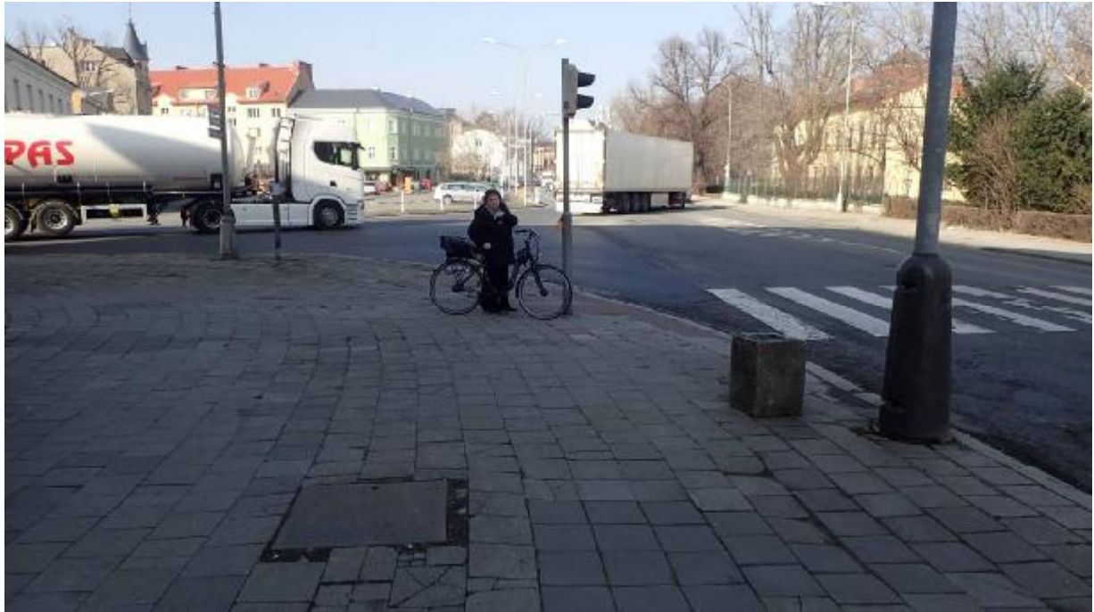
Pohled na jeden z řešených přechodů – bude prodloužen signální pás a napojena na vodící linii, zřídí se vodící pás přechodu v ose přechodu, včetně doplnění reliéfní dlažby na okrajích vozovky.
